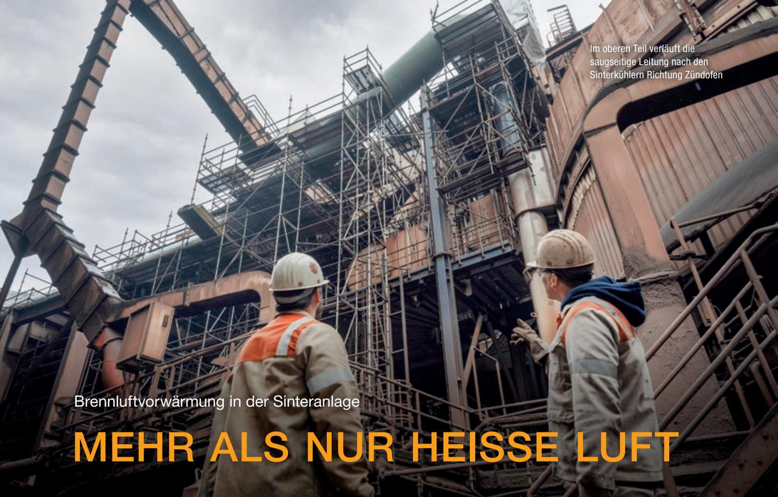
Im oberen Teil verläuft die saugseitige Leitung nach den Sinterkühlern Richtung Zündofen
