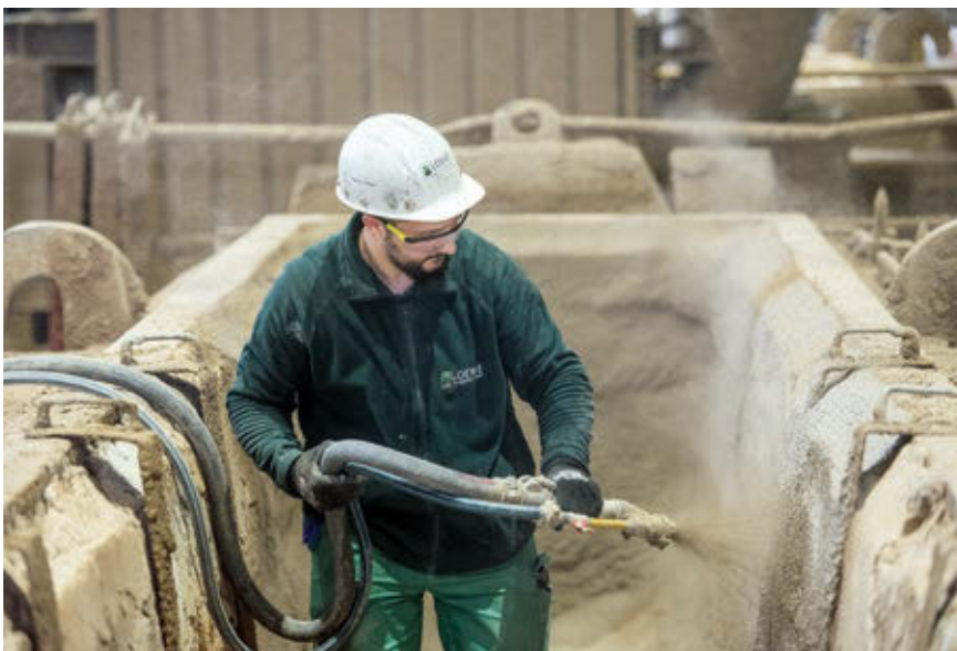
Rhamon Miftari bringt hier eine Schlämpspritzmasse in einer Verteilerrinne auf, um diese später gießfertig zu machen.
