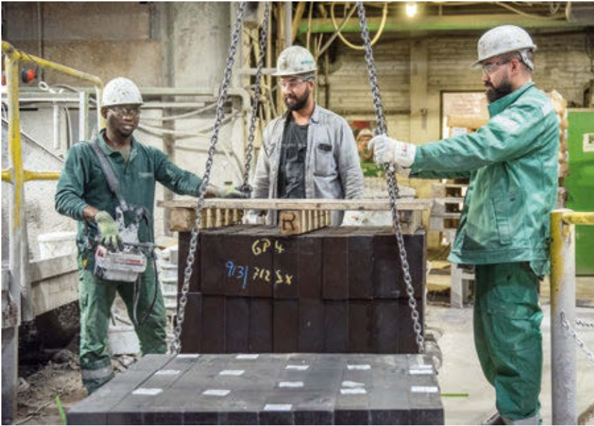
Yussuf Jamal, Sefa Ascı und Burak Ünal (v.l.) beim Anschlagen einer Steinpalette zur Zustellung des Verschleißfutters einer Stahlgießpfanne.
