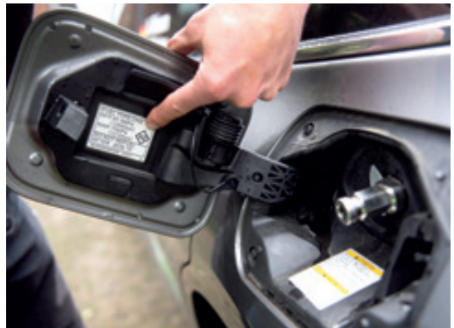
Warnzeichen und wichtige Daten beim Betanken eines H 2 -Fahrzeuges.
