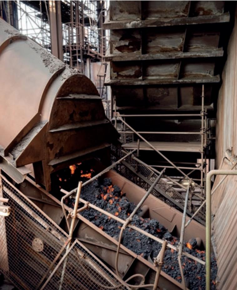
Glühender Sinter nach dem Abwurfschacht auf dem Heißplattenband SB4 an der Sinteranlage
