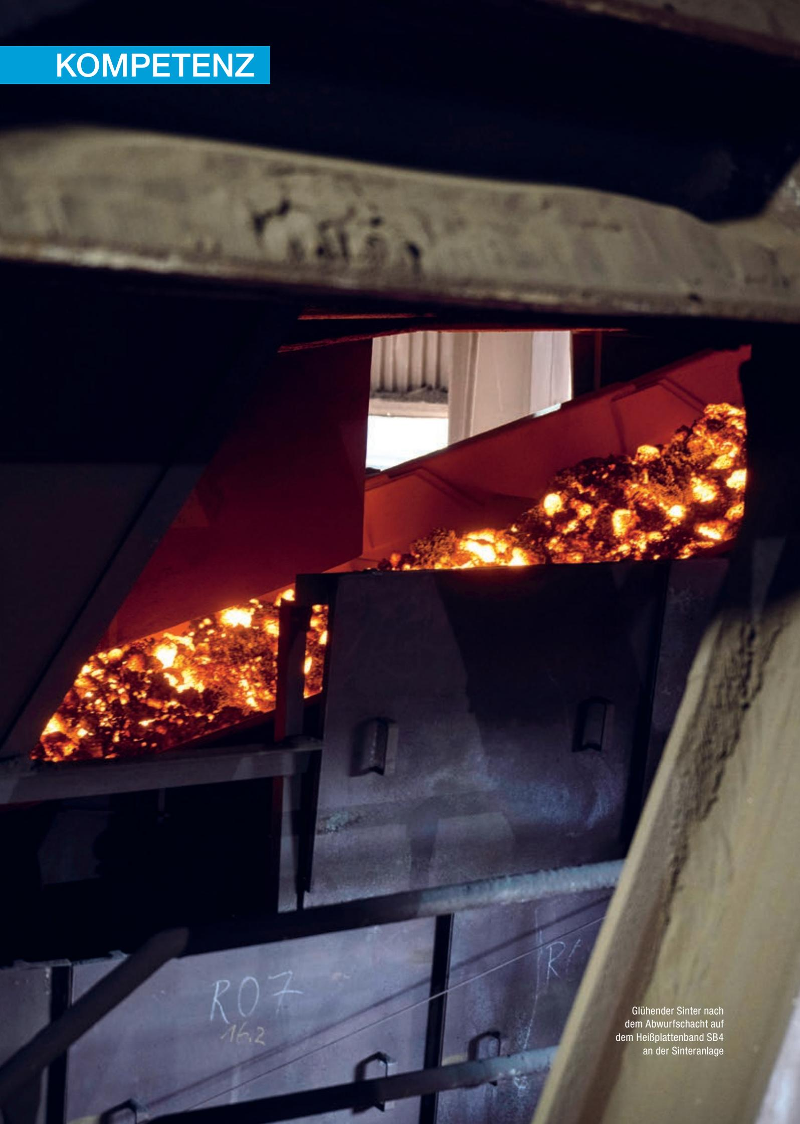
Glühender Sinter nach dem Abwurfschacht auf dem Heißplattenband SB4 an der Sinteranlage
