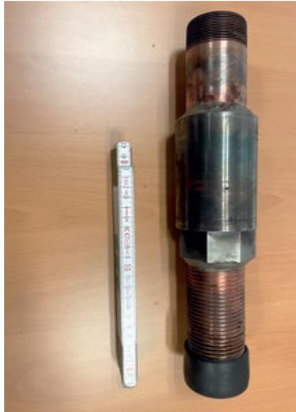
Die Spezialanfertigung des Anschlussrohres für Raststave 12 am Hochofen B
