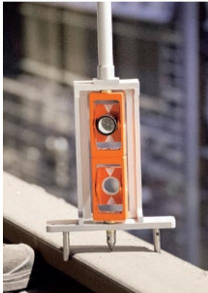
Kranschienenvermessung im Stahlwerk mit selbstentwickelter Schienenmesshilfe
