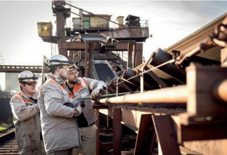
Mitarbeiter bei einem Rollenwechsel am Mischgutband MB16
