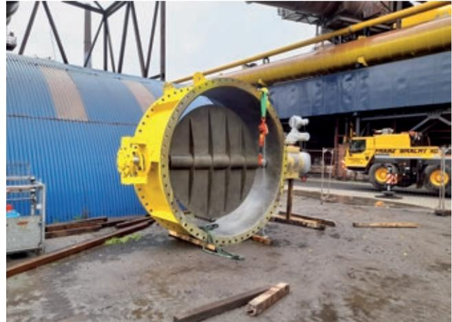
Die neue Drosselklappe steht bereit für den Einbau
