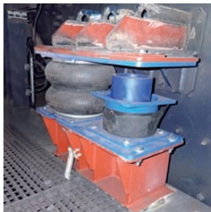
Umbau von Stahl- auf Luftfederung bei den Kokssieben
