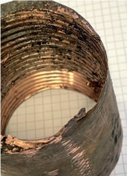
Die Schäden am Anschlussrohr des Restave 12 sind hier deutlich zu erkennen
