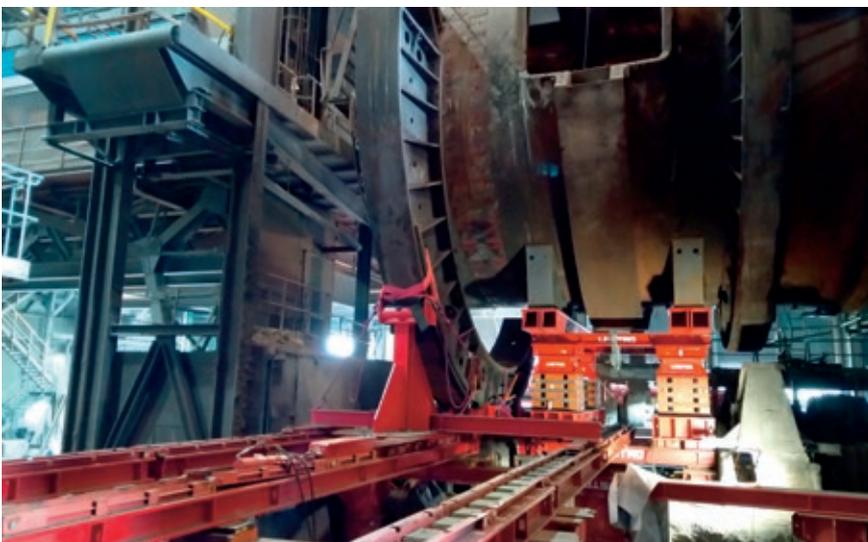
Angepumpter Mischer: Einfahren eines neuen Laufsegmentes ...
