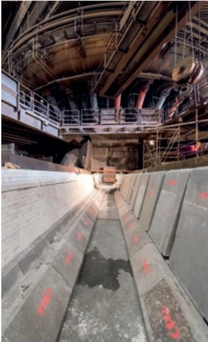
Haupttrinnenzustellung: Der Stahlbau ist fertiggestellt, das Dauerfutter eingebracht. Es fehlt nur noch das gegossene Verschleißfutter.
